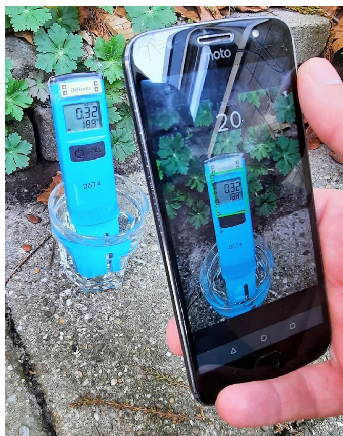
Figuur 3: Het vastleggen van een met de Hanna Dist4 EC meter gemeten zoutconcentratie met de Nitraat App (links) en 1 maand zoutconcentratie metingen in Zeeland (rechts).
