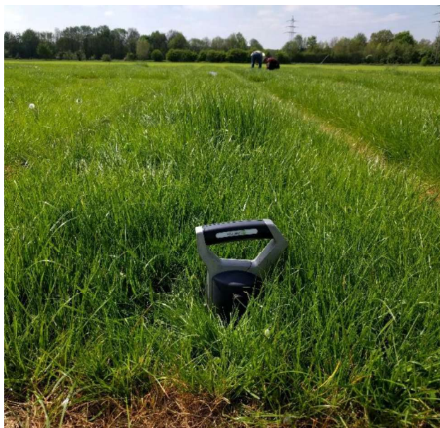
Figuur 6. Links de HandHeld scanner van Agrocures en rechts een directe meting in grasland.
