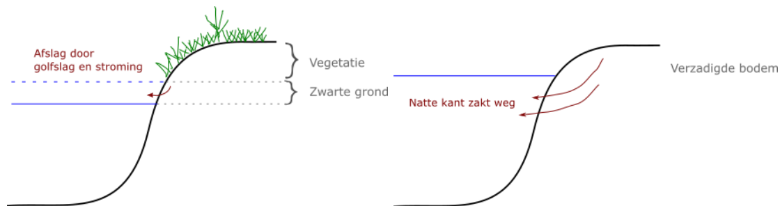
Figuur 5-1. Schematisatie van de relatie 'Vegetatie' en peil: de gedeelten zonder vegetatie zijn extra gevoelig voor afkalving.
